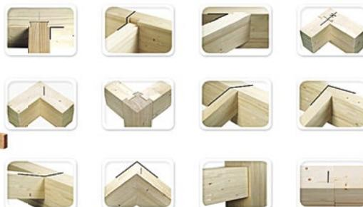
L'uso del centro taglio risolve tutte le problematiche di taglio, intestatura, fresatura, profilatura, foratura ed esecuzione degli incastri e garantisce l'esatta realizzazione delle lavorazioni sulle travi alla precedente fase di progettazione.
