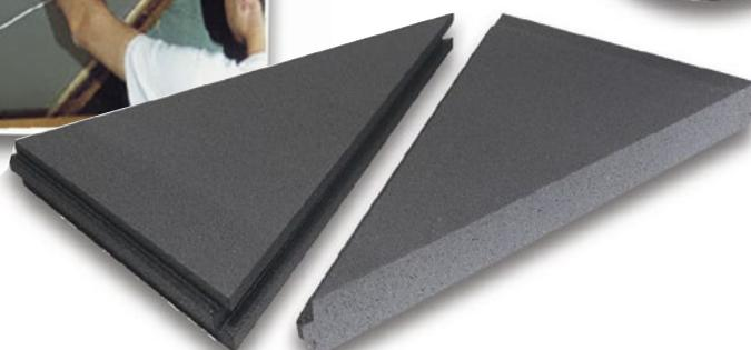
I pannelli **ISOLPIÙGRAF REGOLO** sono un'ottima soluzione per l'isolamento termico in intradosso delle coperture lignee, questi pannelli in polistirene espanso a lambda migliorato sono dotati di battente sui due lati corti ed incastro sulla diagonale che permettono al pannello di assumere dimensioni variabili adattandosi perfettamente agli interassi delle travi di falda.
